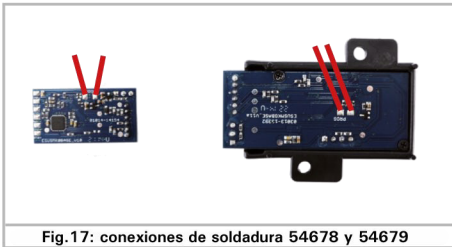
Fig. 17: conexiones de soldadura 54678 y 54679
